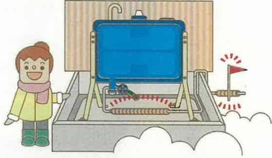
除雪による配管の破損を防ぐために目印を立てておきましょう。また、万一に備え防油堤を設置しておく安心です。
